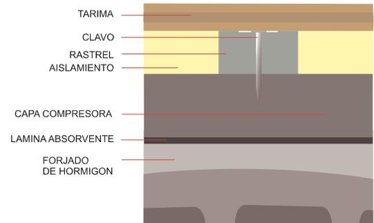
El sistema Rastrel-Impact está compuesto por rastreles de madera tratada antihumedad que incorpora elementos antivibratorios para un aislamiento efectivo del ruido de impacto y ruido aéreo.
